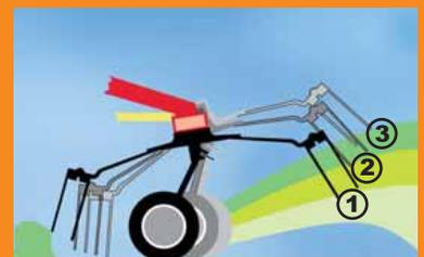
Werkzeuglose Streuwinkelverstellung in drei Stufen. Gleichmäßige Belastung beider Zinkenhälften verlängert die Lebensdauer erheblich.
