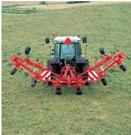
Serienmäßig extra breite Reifen unter der Mittelmaschine für den 8090 und 8090 C.
