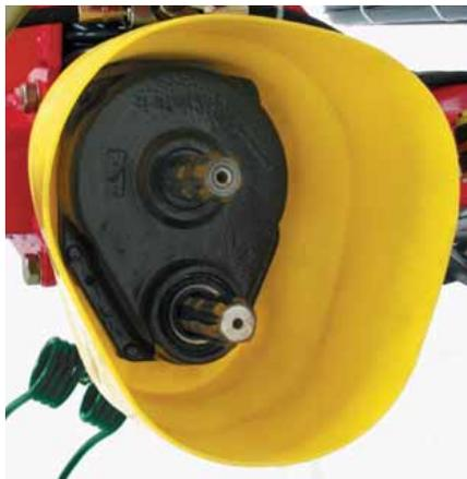
Reduziergetriebe für Nachtschwaden.
