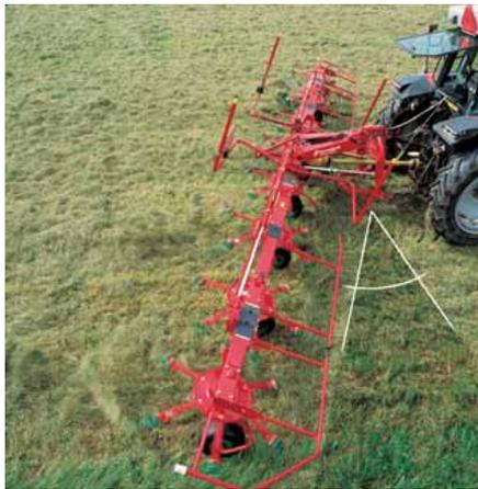
Zum Zetten am Feldrand wird die Maschine in den richtigen Winkel geschwenkt. Die gesamte Bedienung erfolgt aus der Schlepperkabine.
