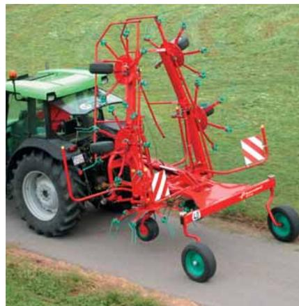
Der 8076 kann durch Anbau des Fahrgestells jederzeit zu einer gezogenen Maschine umgerüstet werden.
