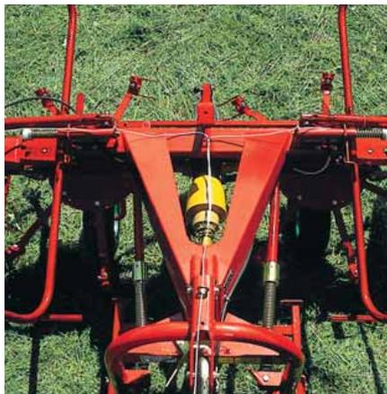
Die speziell konzipierten Tragrahmen mit extrem breiter Anlenkung verleihen der Maschine absolute Laufruhe und Stabilität.
