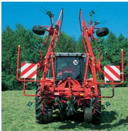
Hydraulisch: 8055, 8068 und 8076 lassen sich bequem von Transport- in Arbeitsstellung klappen. Die Transportbreite beträgt unter 3 m.
