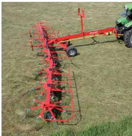
Serienmäßig ist der 80140 C mit einer Grenzstreueinrichtung ausgestattet. Die drei äußeren Kreisel auf der rechten Seite werden über einen Hydraulikzylinder zum Grenzstreuen verstellt
