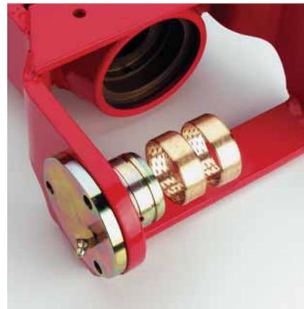
Die Gelenkpunkte sind extrem breit ausgelegt, speziell gelagert und können nachgeschmiert werden. Für dauerhafte Einsatzsicherheit.
