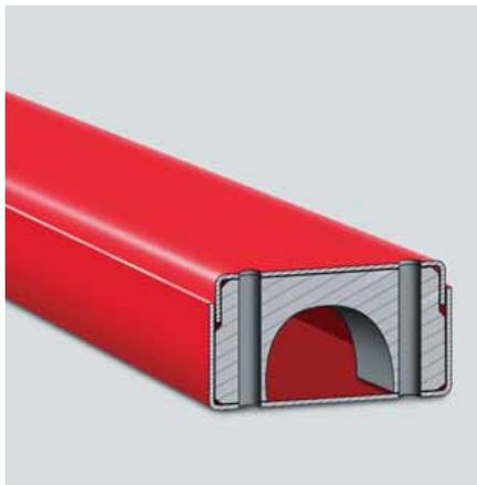
Der Rechteckprofil-Träger ist mehr als nur ein einfaches Kastenprofil: Zwei ineinander geschobene und durchgehend verschweißte U-Profile, kombiniert mit zusätzlichen Stützelementen, gewährleisten höchste Belastbarkeit im Dauereinsatz.
