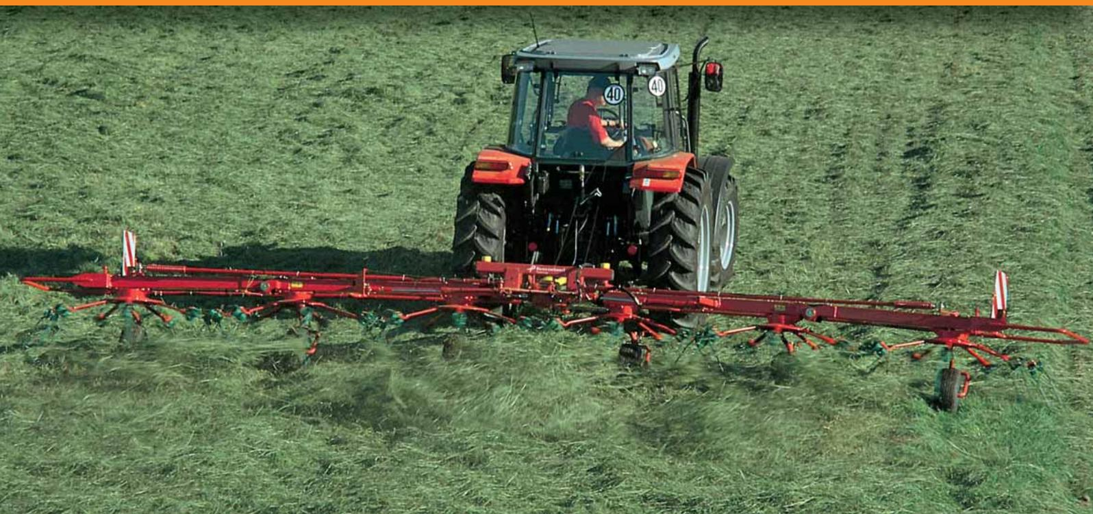
Der 8083T und 80111T sind gezogene Maschinen, die Ihnen nahezu allen Komfort einer Dreipunkt-Maschine bietet. Beide Maschinen lassen sich auf einfache Weise von Transport in Arbeitsstellung umstellen. Dabei müssen Sie noch nicht einmal den Schleppersitz verlassen. Alles was Sie brauchen ist ein doppelt wirkendes Steuergerät und los geht's.
