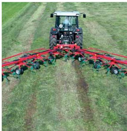
Die Räder unter den äußeren Kreiseln sind geführt, so dass sie...
