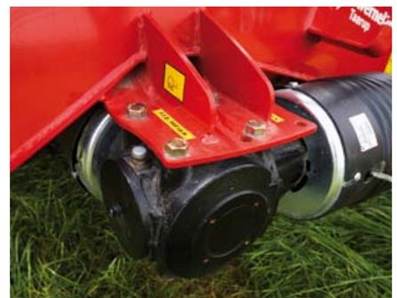
Die Zapfwellengeschwindigkeit kann durch drehen des Getriebes von 540 auf 1000 U/min geändert werden.
