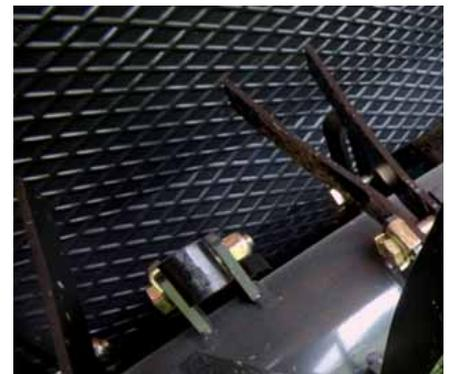
Die Aufbereiterplatte ist mit Fischhautstruktur versehen. Diese Struktur unterstützt den Aufbereitungsprozess und verkürzt die Trocknungszeit.
