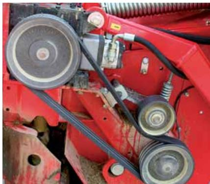
Antrieb des Aufbereiterrotors durch drei Keilriemen.
