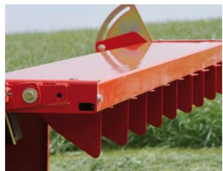
Mit der optionalen FlipOver-Ausrüstung erfolgt das Umschalten zwischen Schwadablage und Breitablage in nur wenigen Sekunden.
