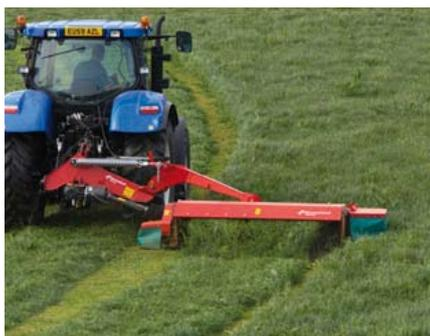
Einfach für unterschiedliche Bedingungen einstellbare Rotordrehzahl.
