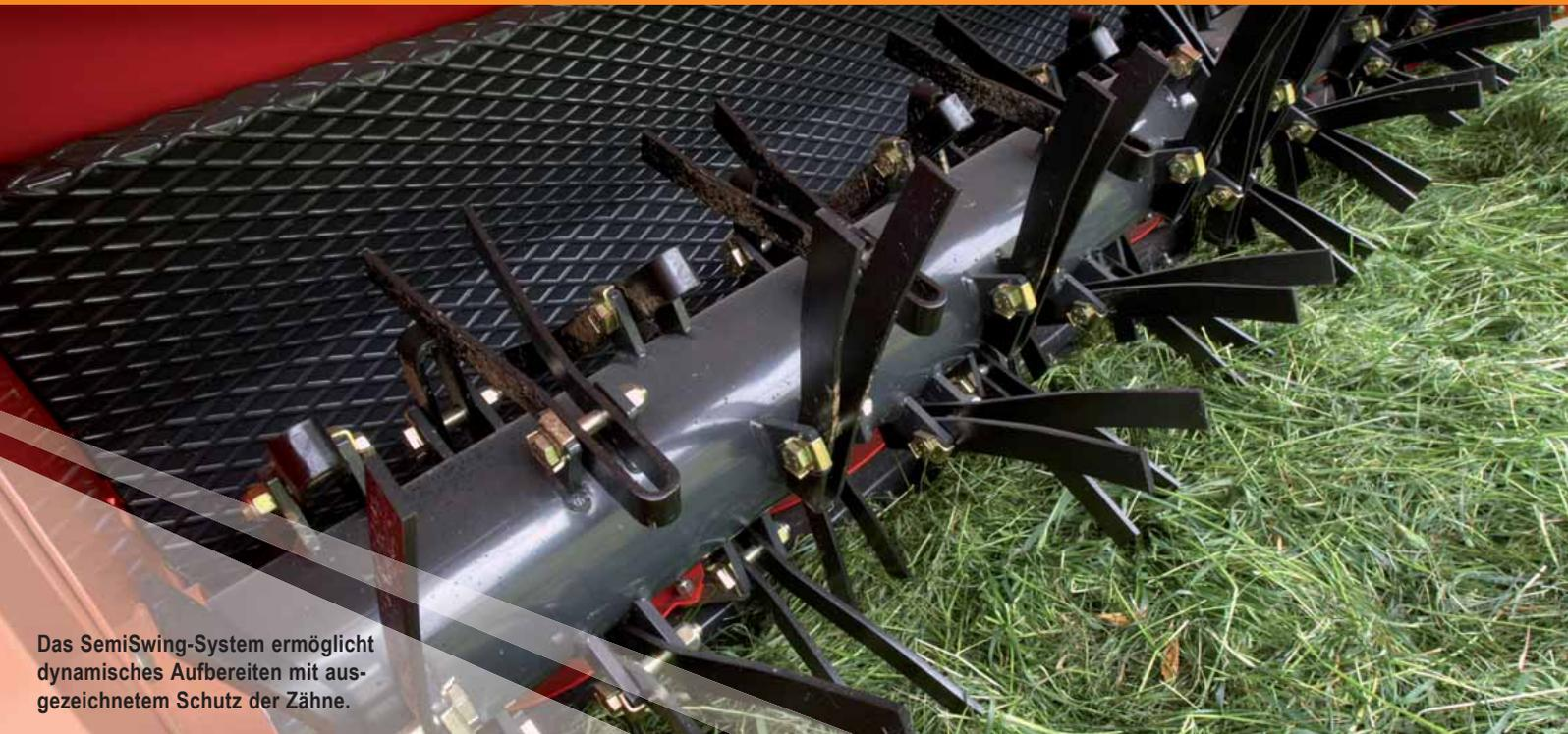
Das SemiSwing-System ermöglicht dynamisches Aufbereiten mit ausgezeichnetem Schutz der Zähne.
