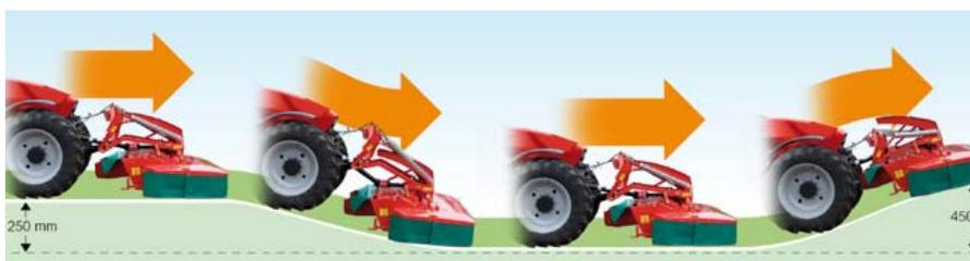
Die Aufhängung der Mäheinheit erlaubt eine Boden Anpassung von 250 mm nach unten und 450 mm nach oben.
