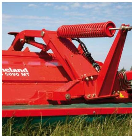
Die Schwadablegebänder von Kverneland Taarup sind einzeln aufgehängt – für gleichmäßige Schwadformung.
