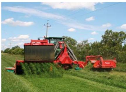
Jede Mäheinheit kann einzeln von der Traktorkabine aus kontrolliert werden. Bei Bedarf kann man so auch nur mit einer oder zwei Einheiten arbeiten.
