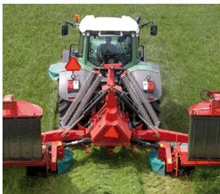
Vier groß dimensionierte Entlastungsfedern sichern gleichmäßige Federung und Schnitthöhe.
