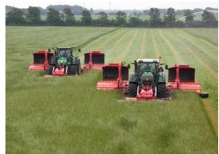
Wenn die Schwadverlegerbänder nicht in Gebrauch sind, werden sie einfach hydraulisch nach oben geschwenkt.
