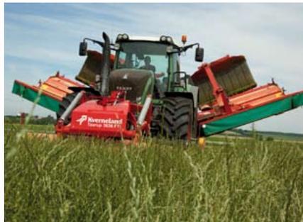
Trotz der Größe ist die Kverneland 5090 MT Kombination am Vorgewende sehr einfach zu handhaben. Jede Einheit kann per einfacher Bedienung eines Knopfs in der Kontrollbox hochgeklappt werden.
