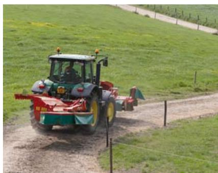
Für den Transport wird die Maschine hydraulisch in eine horizontale Position hinter dem Schlepper geschwenkt.
