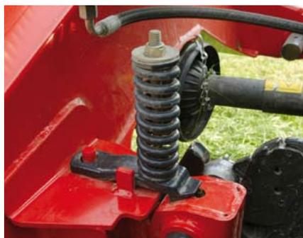
Anfahrssicherung für optimalen Schutz des Mähbalkens.
