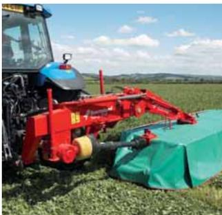
Hydraulische Aufhängung für präzise Einstellung des Bodendrucks.
