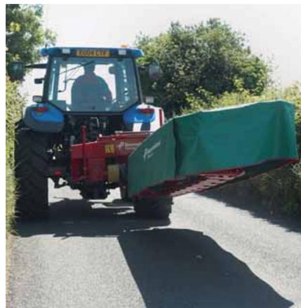
Das Kverneland 2540 H Mähwerk ist für den Transport in waagerechter Position fest verriegelt. Dies sichert die freie Sicht nach hinten während des Transports.
