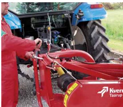
Eine starke Ausgleichsfeder sorgt für eine optimale Aufhängung des Mähbalkens des Kverneland 2600. Das Ergebnis ist eine optimale Bodenentlastung des gesamten Mähbalkens bei unterschiedlichen Bedingungen und Bodenkonturen. Die Bodenentlastung lässt sich einfach und präzise mit einer Feder einstellen.
