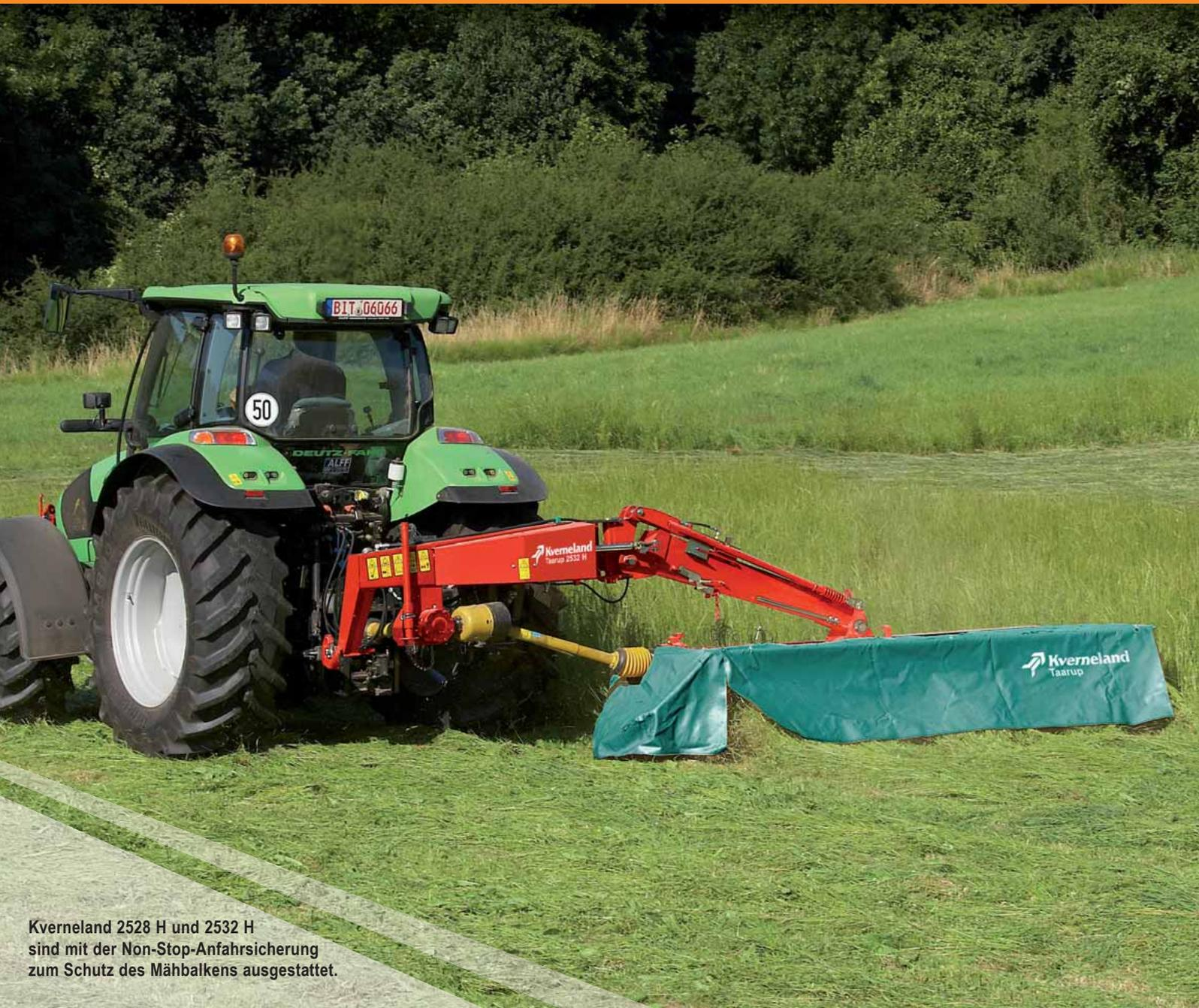
Kverneland 2528 H und 2532 H sind mit der Non-Stop-Anfahrtsicherung zum Schutz des Mähbalkens ausgestattet.
