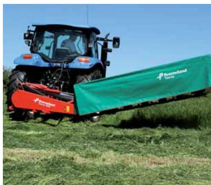
Der Aushub am Vorgewende erfolgt über einen Hydraulikzylinder, so dass die Schlepperhydraulik nicht betätigt werden muss. Die voreingestellte Arbeitshöhe der Schlepperhydraulik wird so während der Arbeit nicht verändert.
