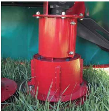
Der 10-scheibige Mähbalken wird durch einen direkten Antrieb vom Getriebekasten zur ersten Scheibe angetrieben. Dieser Antrieb reduziert den Kraftverlust und gewährleistet, dass die volle Arbeitsbreite des Mähbalkens ausgenutzt wird.
