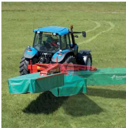
Für den Transport wird der Mäher hydraulisch hinter den Schlepper in waagerechte Position geschwenkt. Die Umstellung erfolgt schnell und einfach, ohne den Schlepper verlassen zu müssen.
