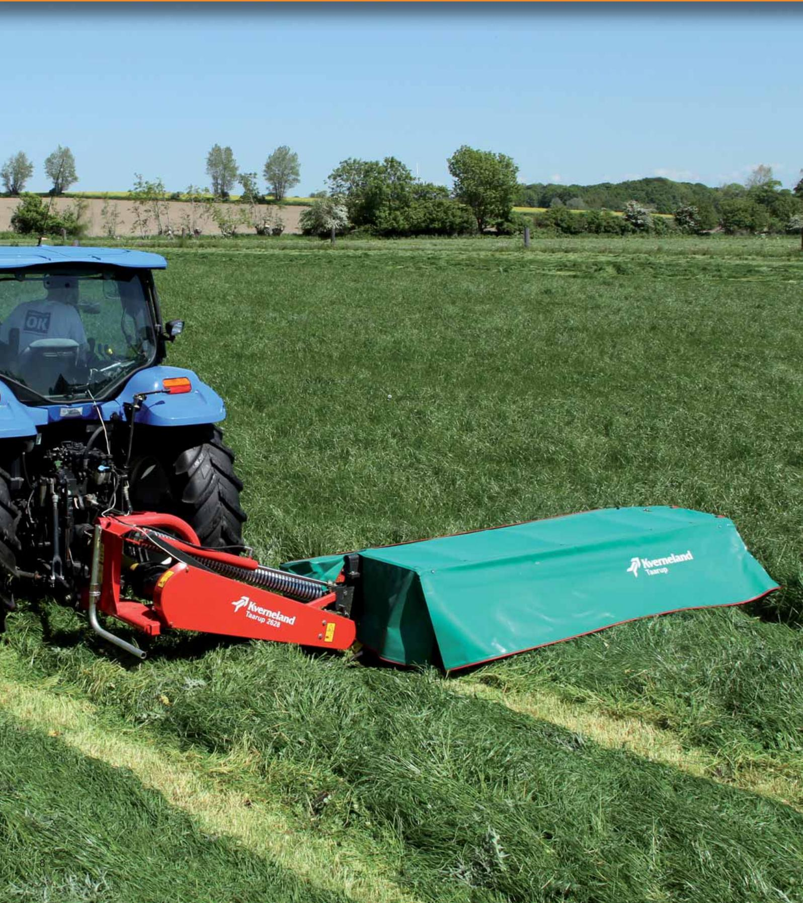
Bei den heckmontierten Scheibenmäherwerken bietet Kverneland Arbeitsbreiten von 2,00 bis 3,20 m an. Das Kverneland 2600 Scheibenmäherwerk überzeugt durch sehr zuverlässige Arbeitsleistung, einfache Bedienung und geringe Anforderung an die
