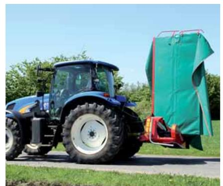
Für den Transport wird die Maschine von der Schlepperkabine aus hydraulisch in eine vertikale Transportposition direkt hinter dem Schlepper geklappt, die einen stabilen und sicheren Transport ermöglicht.
