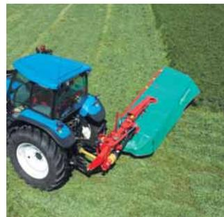
Anheben und Wenden auf dem Vorgewende erfolgt ohne den Dreipunktbock des Schleppers zu betätigen.
